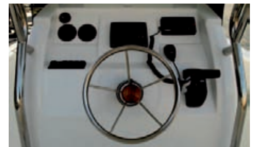
En el panel de gobierno se pueden repartir los indicadores del motor, un equipo multifunción, la radio, el cuadro de interruptores del barco y la palanca de aceleración, además del compás. Aunque no estaría de más una guantera para objetos personales.
