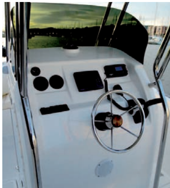
La altura del parabrisas, la de la consola y la anchura de ésta cumplen con las dimensiones idóneas para el puesto de gobierno.
