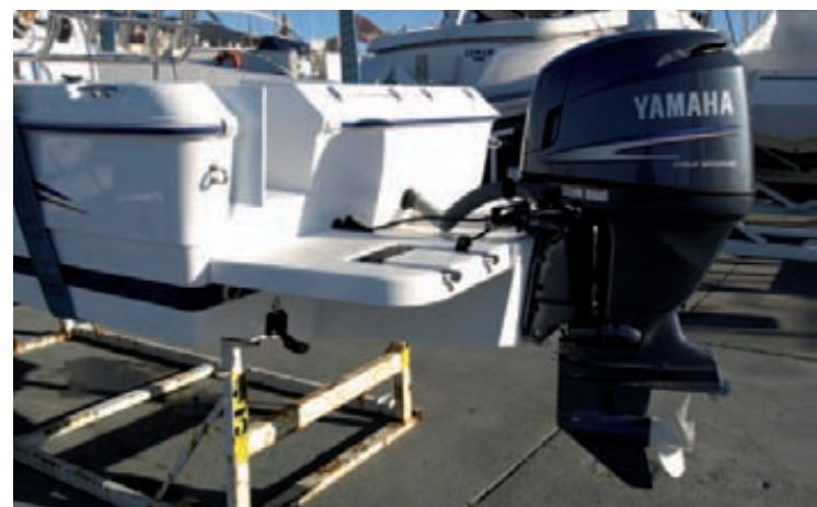
Una de las claves de la versión 2010 de esta embarcación es el bracket. Se gana en eslora de flotación proporcionando una mejor navegabilidad y dejando la popa libre.
