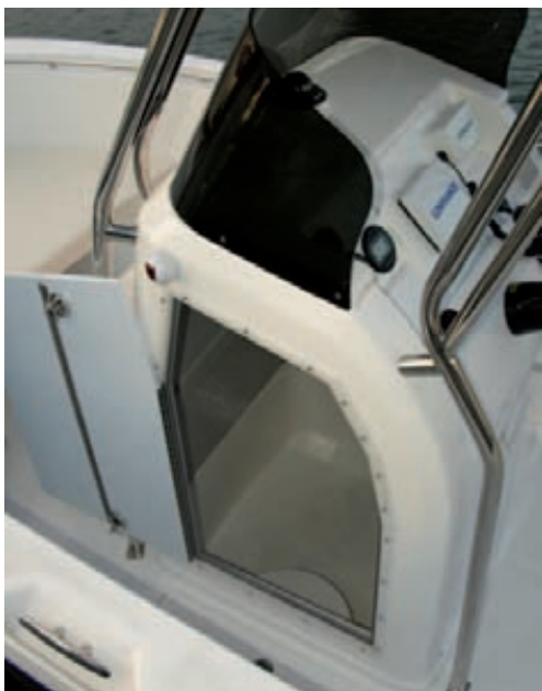
En el interior de la consola hay espacio suficiente para instalar un inodoro químico, o si se prefiere, para compartimentar adecuadamente el volumen disponible.
