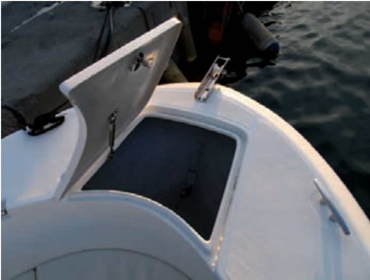
La proa de la 20 CC además de disponer de un enorme cofre, ha añadido en la nueva versión una roldana para deslizar la línea de fondeo.
