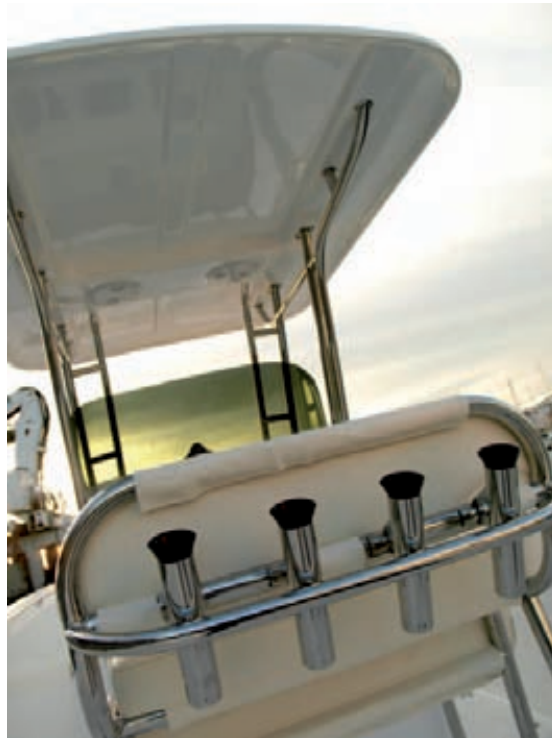
La parte posterior del asiento del piloto cuenta con cuatro cañeros.
