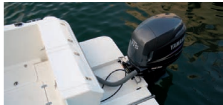
La plataforma de popa, con la escala de baño integrada y una puerta de acceso directo a la bañera, es en realidad un robusto bracket —cuyo diseño estructural en aluminio y fibra está patentado—, solidario a la carena del barco.
