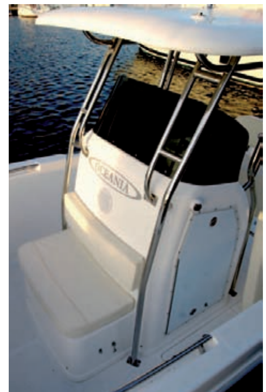
La parte delantera de la consola está ocupada por un asiento, debajo del cual se encuentra un gran cofre de estiba.
