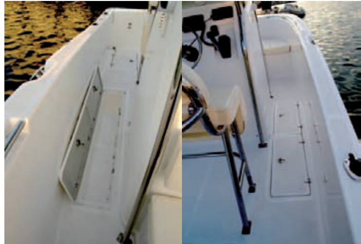
Los pasos a los lados de la consola son anchos. En la nueva versión los cofres alargados del piso de la bañera ahora son dobles, con sus respectivas tapas, más cómodos para manipular que antes, que eran de una sola pieza.
