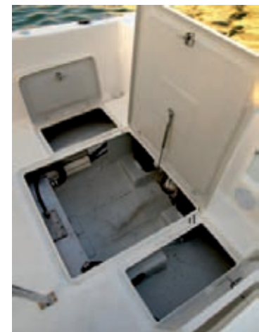
En total, la 20 CC dispone de nada menos que de 16 tapas con huecos para estiba. La popa es una buena muestra del aprovechamiento de los volúmenes.
