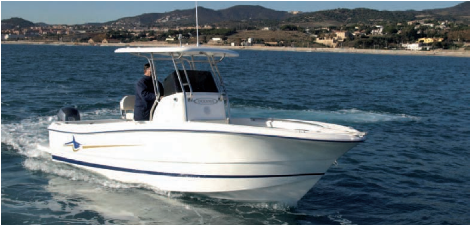
La Oceania 20 CC es un modelo de consola central muy seco en bañera gracias a su elevada V de proa.
