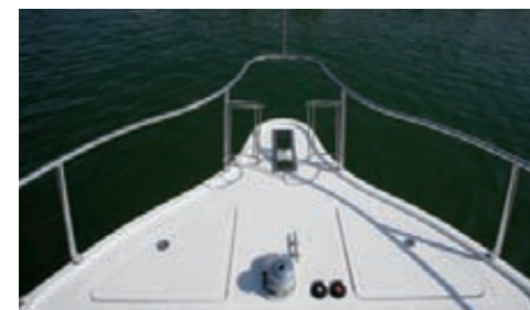
La maniobra de proa se ha dispuesto de forma muy eficaz, limitando al máximo los apéndices sobresalientes de la cubierta.
