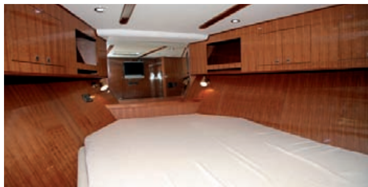
La cabina del armador presenta todos los mamparos forrados de madera, pero en próximas unidades habrá más superficies tapizadas para ganar en luminosidad.
