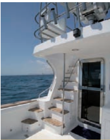
La escalera de acceso al flybridge forma parte de la superestructura, tiene una pendiente moderada y los peldaños están forrados de gruesa teca.
