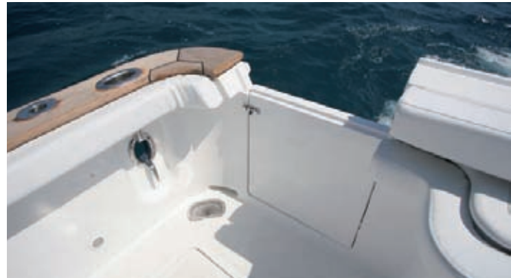
La puerta de popa está acertadamente dividida en dos secciones. La superior se abre hacia arriba y se recoge sobre el mismo espejo, mientras que la sección principal se abre hacia fuera para impedir su apertura accidental ni que ocupe espacio en la bañera.
