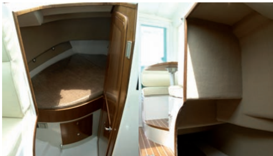
El mueble de la cocina ocupa la parte posterior del asiento del piloto: cajones, armario y fregadero completan el conjunto.
