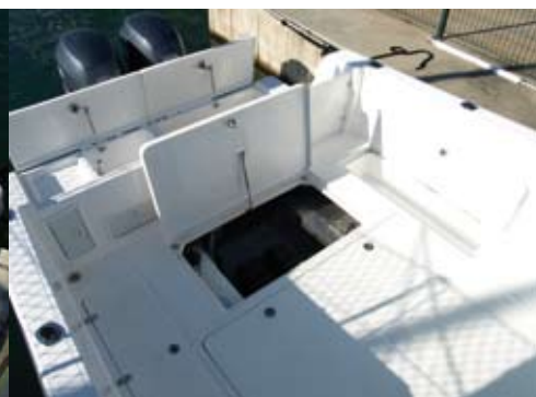
Las dimensiones de la bañera se benefician de la notable manga del barco. No faltan cofres, ni cañeros, ni otros elementos necesarios para la práctica de la pesca.
